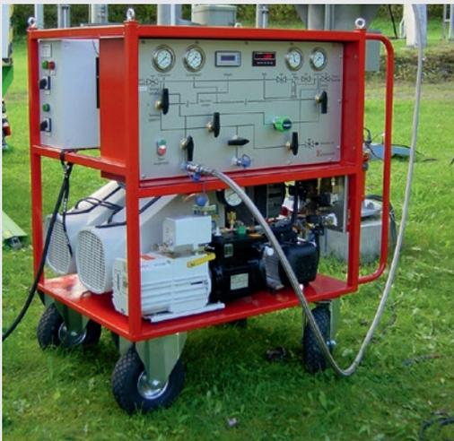
Zur Wartung gasisolierter Schaltanlagen werden portable Rückgewinnungsanlagen verwendet, die aus einer oder mehreren Vakuumpumpen, einem Filter und einem HAUG Sauer Kompressor bestehen.
